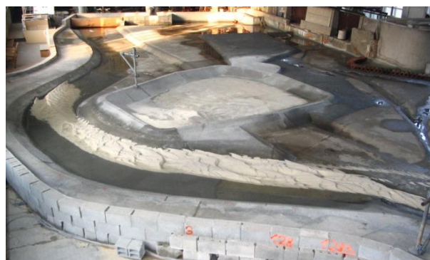
Slika 11: Ostanke proda na konveksni strani obtočnega kanala po 27 urah pri spodnjem robnem pogoju 143,96 m n. m. in pretoku Q = 1800 \text{ m}^3/\text{s} .
