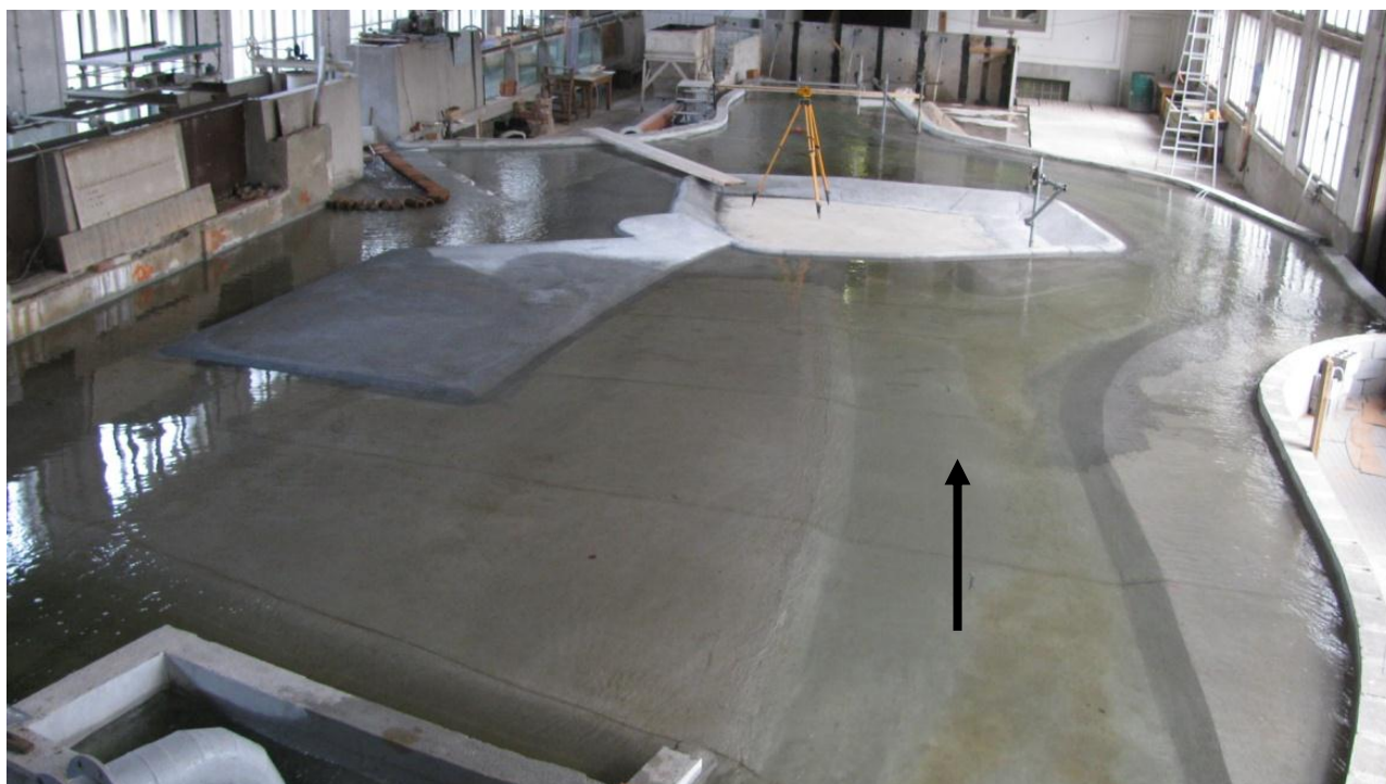
Slika 1: Fizični hidravlični model HE Brežice z vgrajeno gradbeno jamo in obtočnim kanalom. Puščica označuje smer toka vode.
