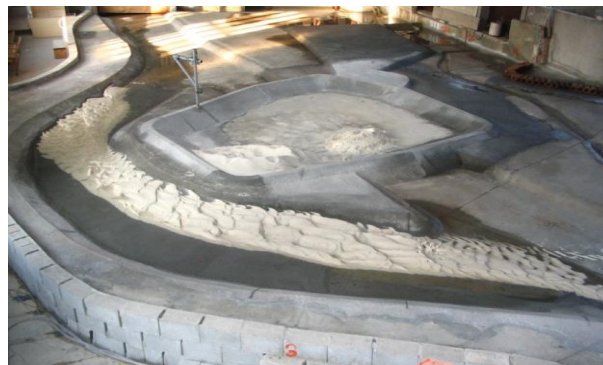
Slika 10: Močna erozija na konkavni polovici obtočnega kanala po 27 urah obratovanja pri pretoku Q = 1800 \text{ m}^3/\text{s} .
