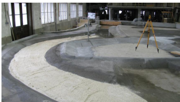
Slika 9: Začetno stanje modelnega proda na projektirani koti dna obtočnega kanala.
