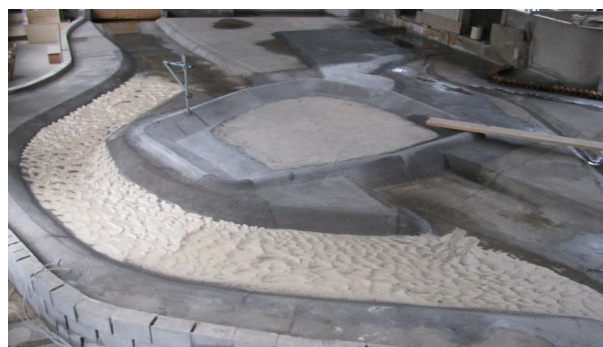
Slika 8: Stanje dna v obtočnem kanalu na fizičnem modelu po 11,7 urah pri pretoku 500 m 3 /s.
