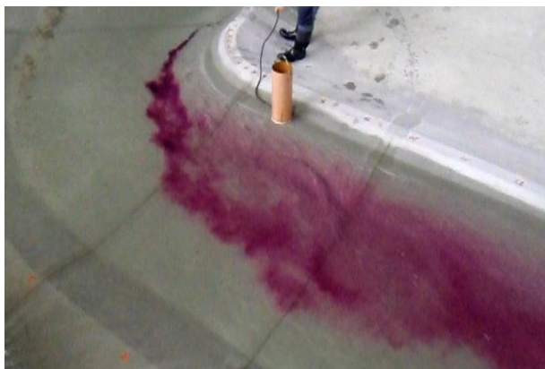
Slika 3: Vrtinčenje vode in mrtva cona s protitokom na zgornjem robu gradbene jame pri pretoku Q = 2460 \text{ m}^3/\text{s} .
