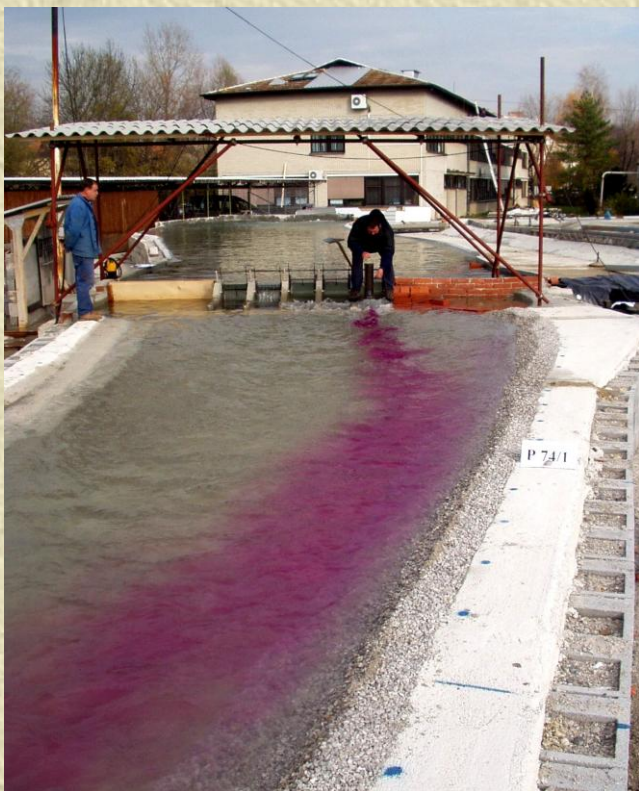
Opazovanje tokovnic ob levem bregu pri Q=1,725\text{m}^3/\text{s}
