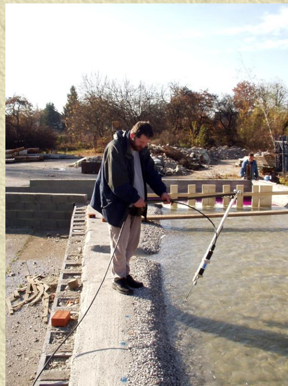
Merjenje hitrosti z ADV sondo ob levi brežini
