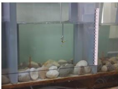
Slika 2.1: Fizični hidravlični model s sondo ADV
