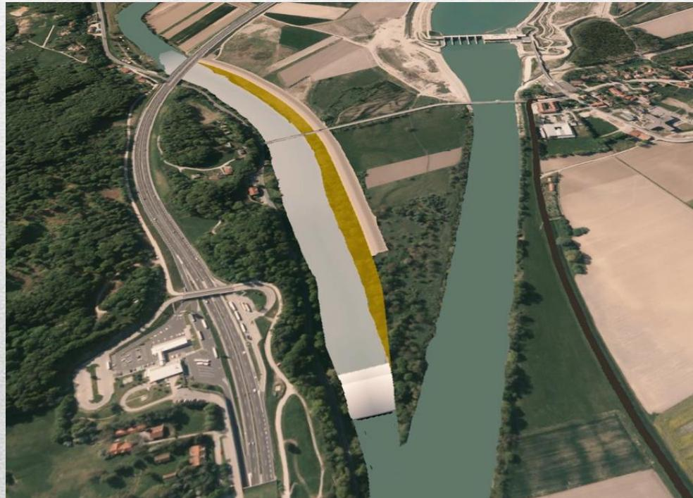
Fizični hidravlični model v merilu 1:30 z gibljivim dnom v dolžini 96m (2,9 km za naravo)
