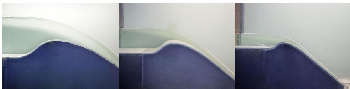
Slika 2.1: Primerjava prelivnega curka na modelih 1:26 (leva fotografija), 1:50 (srednja fotografija) in 1:100 (desna fotografija) za nominalni pretok (t.j. pretok na prototipu) 214 m 3 /s
