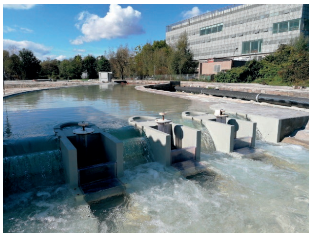
Slika 9: Meritve prelivanja čez zgornjo zapornico; paralelno odprte vse 4 zapornice
