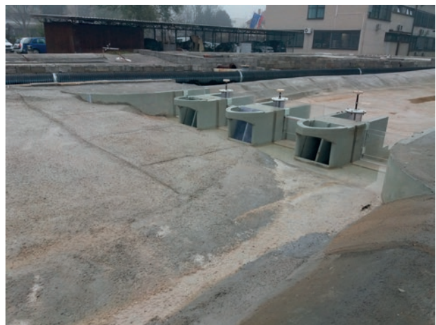
Slika 5: Fizični hidravlični model objekta – pogled iz gorvodne strani
