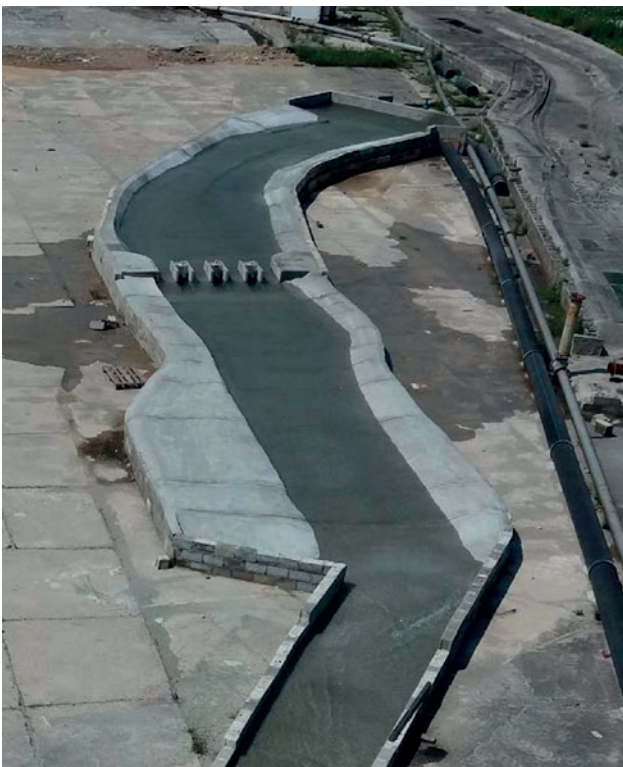
Slika 3: Fizični hidravlični model HE Vuzenica v merilu 1:40 na zunanji laboratorijski ploščadi Inštituta za hidravlične raziskave – pogled iz dolvodne strani
