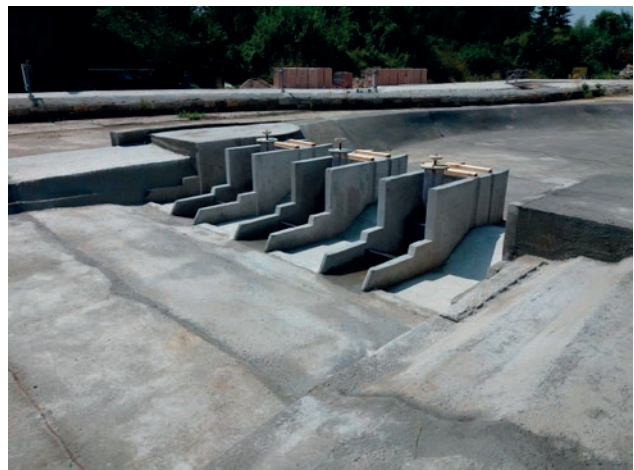
Slika 4: Fizični hidravlični model objekta – pogled iz dolvodne strani
