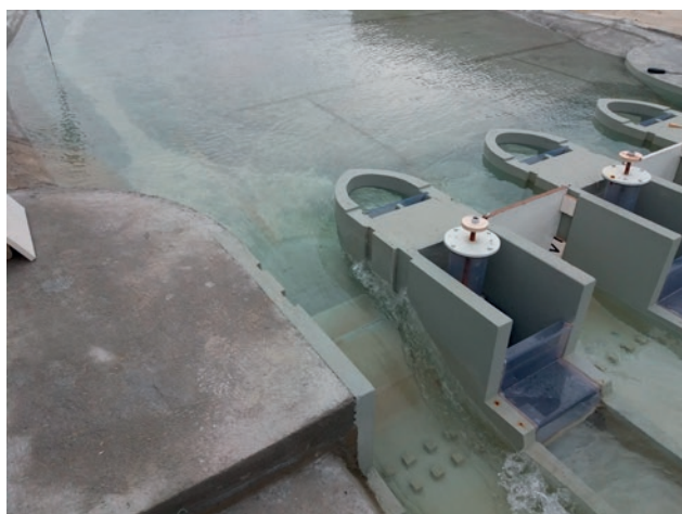
Slika 6: Prosti preliv preko desnega prelivnega polja – obstoječe dno
